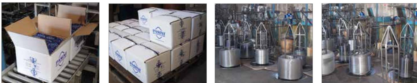
Bindedraht - seitliche Abwicklung (weißer geglähter Draht - weich, formbar, i.d.R. ohne Oxidation), aufgewickelt als Drahtspule/-Rolle (Coil), wird für Ligaturen verschiedener Art verwendet, insbesondere im Baubereich zum Binden von Rundeisen im Stahlbetonbau.
